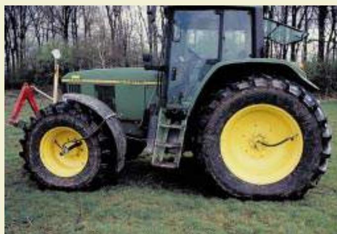
Bodenschonung und mehr Zugkraft beim Ackerreifendruck mit 0,5 bar am Traktor der Agrarwirtschaft Soest. Der niedrige Reifendruck macht die Reifen lang, vergrößert die Aufstandsfläche und spart Diesel.
