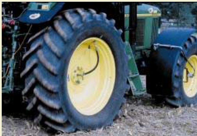
Zugkraftmessung auf dem Acker mit Zug- und Bremstraktor auf dem Feld der Agrarwirtschaft Soest. 25 Prozent mehr Zugkraft, bei gleichem Schlupf, gewinnt man durch einen niedrigen Reifendruck von 0,5 bar.
